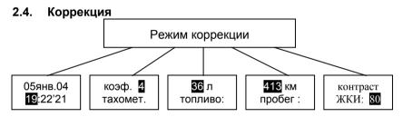
В данном режиме работы Вы можете откорректировать различные заводские параметры БК, настроив БК под конкретный автомобиль. Например, это может потребоваться в случае использования резины нестандартного размера. После первичной калибровки, обычно редко возникает необходимость изменять параметры. В этом режиме Вам доступна корректировка следующих параметров:
